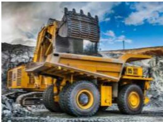
внутри, как по закручивающейся спирали, словно букашки, едут грузовики и Белазы, везущие уголь. Но чтобы добраться до нижних, ценных слоев, сначала нужно убрать верхний грунт, смесь глины и песка. Снимает этот слой экскаватор и ковшом грузит породу в БелАЗы, которые отвозят вскрышу на отвал. Путь от экскаватора до отвала - около 4 километров, за смену водитель делает около 20 рейсов.
